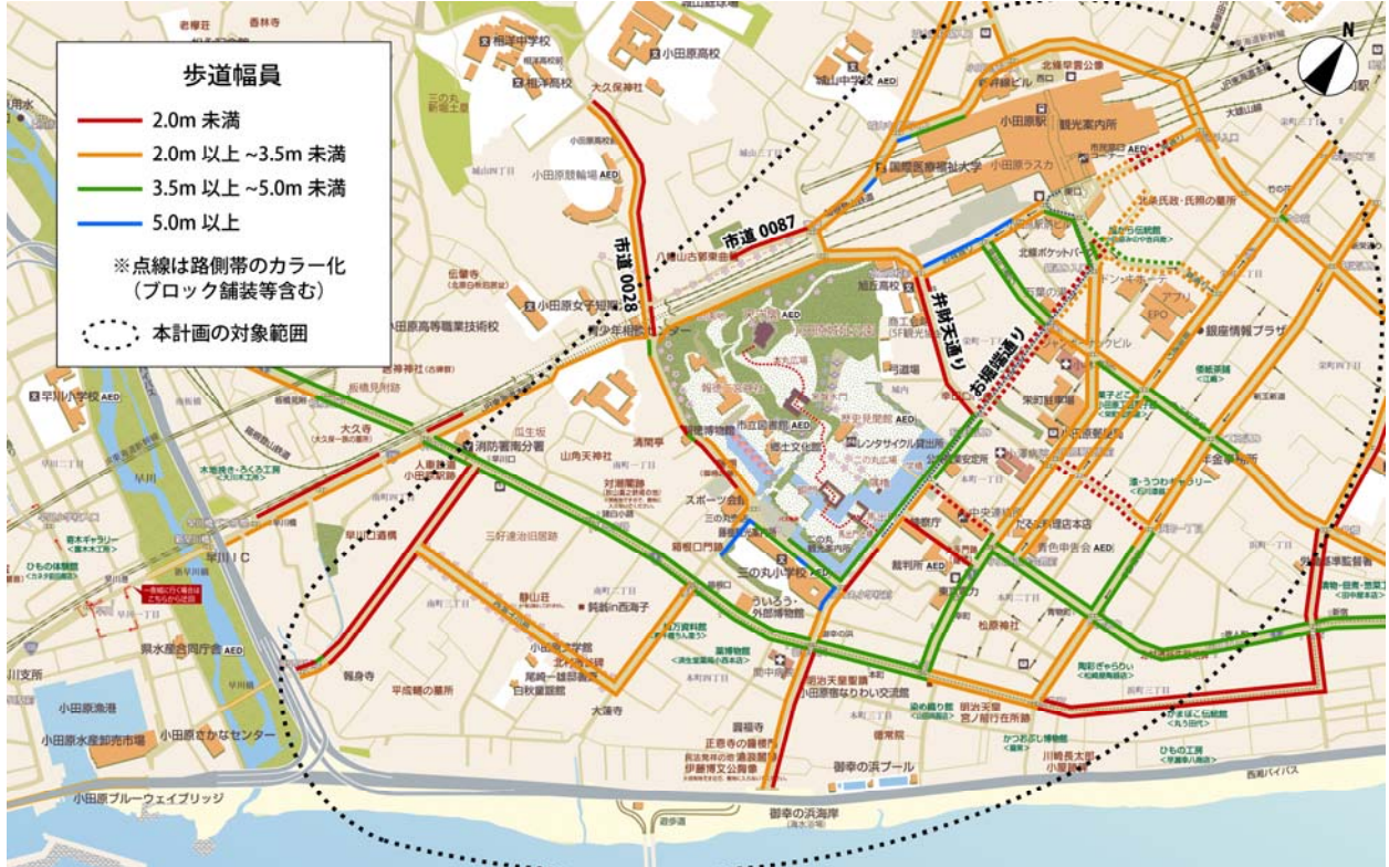
図-25 歩道整備状況
