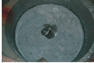
② 機械の中で水に溶かして、液状の製紙原料を作り、テープなど紙繊維以外の異物を取り除きます。
