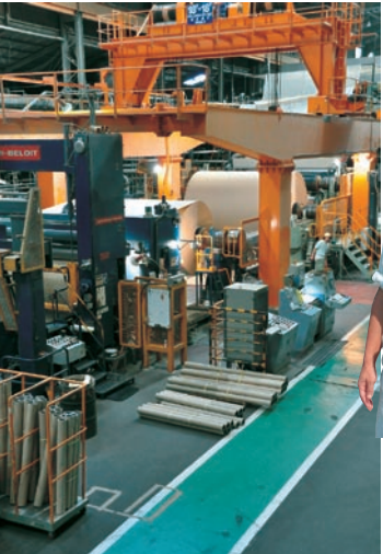
③ 製紙原料を乾燥させ、巻き取ります。
