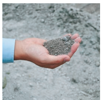
④ 焼却灰。焼却することにより、重量は、約10分の1となります。
