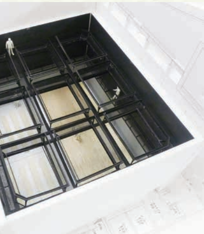
大スタジオ(スタジオ天井に作業通路を設け、公演時などの照明作業などに対応)
