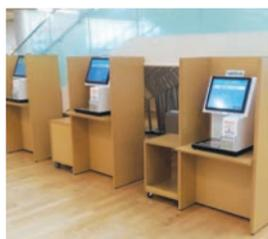
利用者が図書を置くと、ICタグを読み取り、貸し出し処理されます。同時に最大10冊まで、読み取り可能です。
