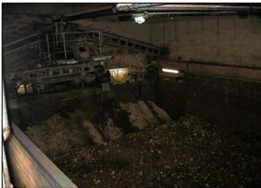
一次発酵槽に生ごみ・畜ふん・籾殻の3原料が投入され、15日かけてパドルとよばれるプレートで攪拌発酵されます。
