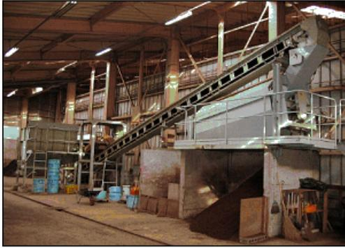
2次発酵が終了した段階で、異物除去を行います。磁選機（電磁石）にて金属を、トロンメルスクリーン（ふるい）にてビニール類・未発酵物を取り除きます。
