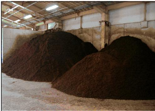
異物除去が終了後、最終発酵段階である3次発酵の工程に入ります。40日間の静置発酵で、2次発酵同様、ホイールローダーにて切り返しを行い酸素を供給します。3次発酵は製品化への最終段階なので、水分調整など細かな配慮を行います。
