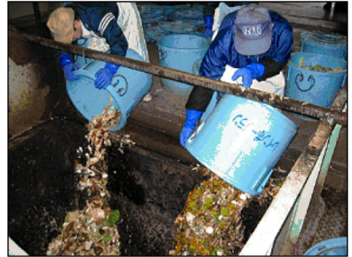
コンポストセンターに運ばれた生ごみは専用の投入口から投入されます。
