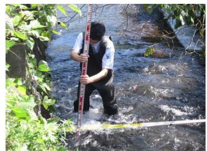
図 小水力発電事業化の候補地での簡易流量調査の様子
