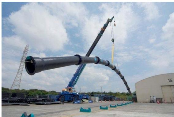
耐震継手の柔軟性検証（クボタ提供写真）
