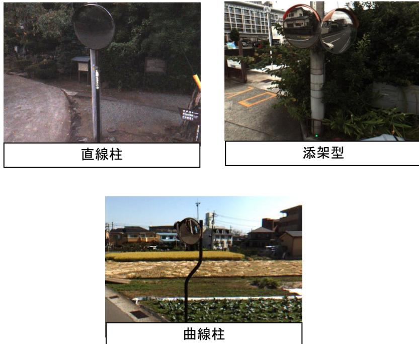
写真 3-11 本市が管理する道路反射鏡の支柱形式
