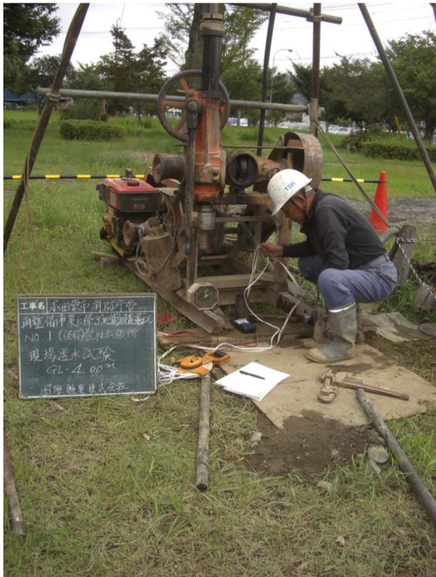
現場透水試験 GL-4.00m
