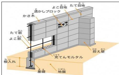
控え壁：コンクリートブロック造の塀等において、壁の外側に壁が倒れないように取り付け補強壁
