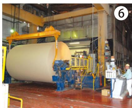
古紙パルプから異物を取り除き乾燥させて巻き取り、段ボール原紙が製造されます。
