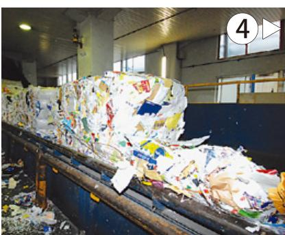
コンベアーに乗せ、1度に4個(約4t)を大きなパルパー(大型ミキサー)へ入れます。
