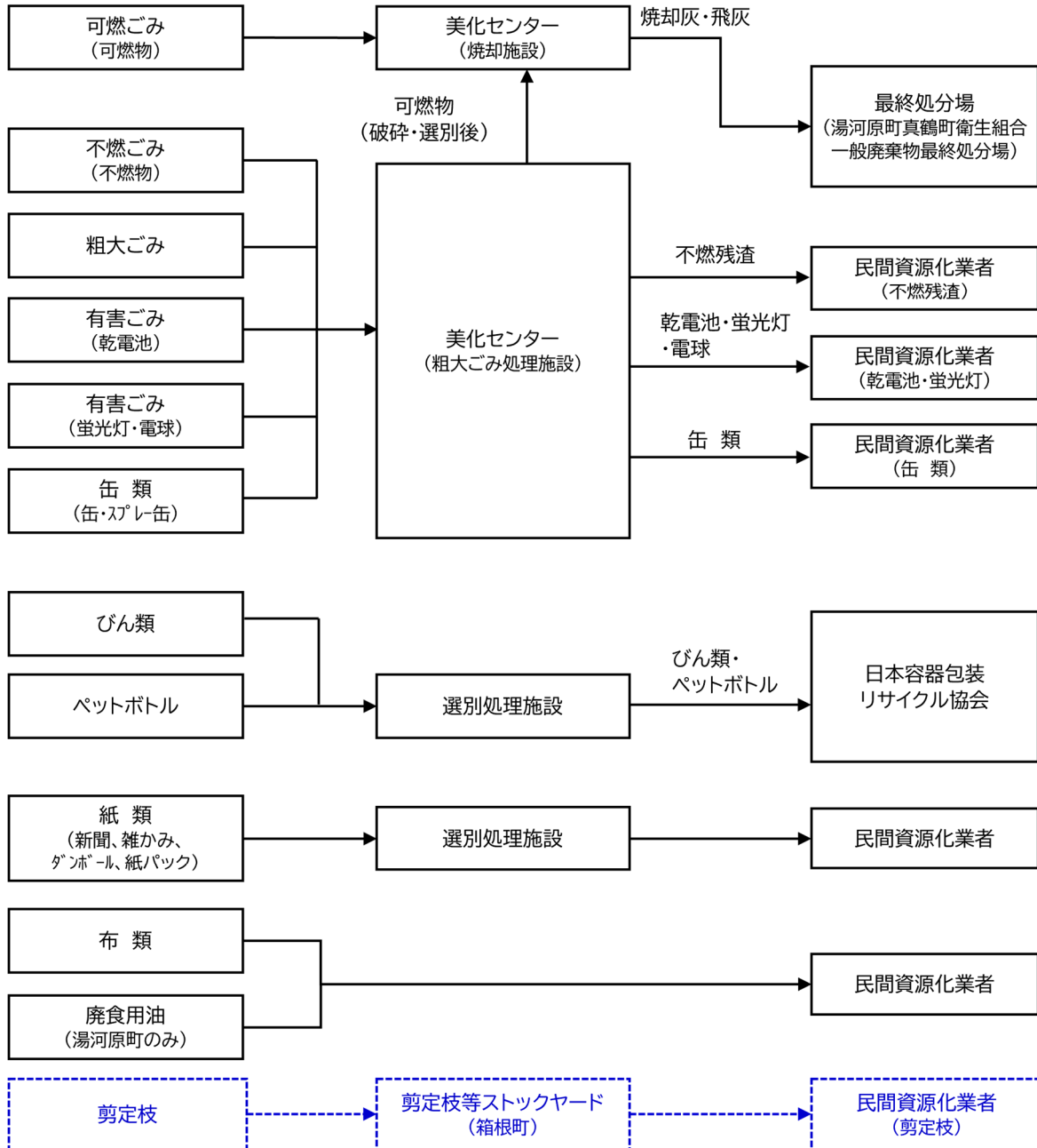
図3.4 湯河原町・真鶴町のごみ処理フロー
