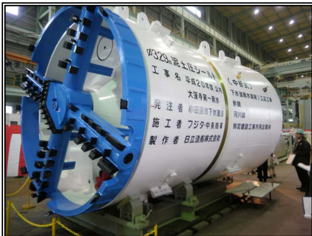
大蓮寺第一雨水幹線整備に使用したシールドマシン
