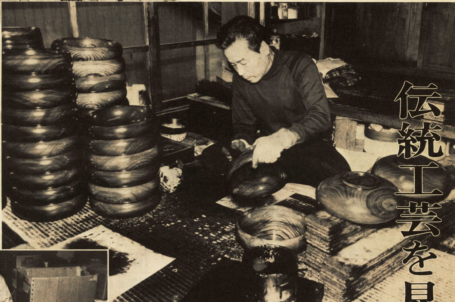
小田原漆器の木地作り。電動ロクロ(木工旋盤)が使われています(上)
