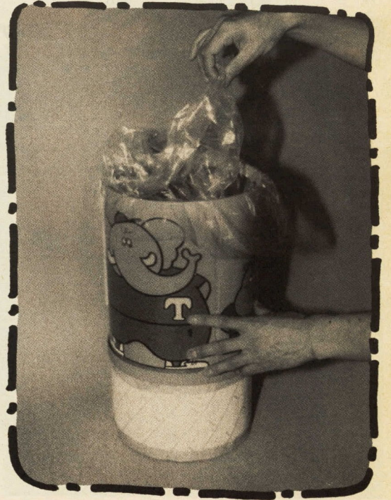
【袋が続いて出るゴミ箱】ゴミがたまったらビニール袋の口をふさいで引っ張ると、ティッシュペーパーのように次のビニール袋がゴミ箱の底から出てきます(城山中の難波くん)
