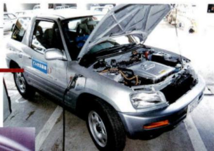
ボンネットの真ん中には、コントロールユニットが。モーターはこの下にあり、バッテリーは床下。水冷のラジエターもちゃんとあります。フロントフェンダーにあるのは充電ケーブルのさし込み口。
