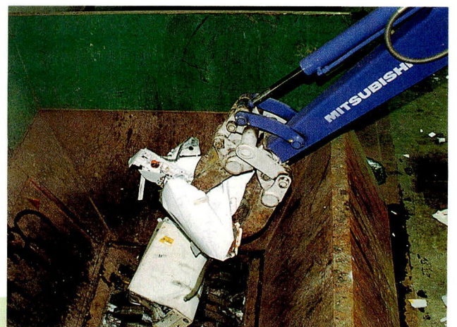
大型ごみは機械で細かく碎かれ選別される
