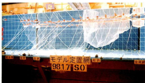
ハイテック定置網の模型 (1/150) 海水産総合研究所相模湾試験場 (厚川) では、毎日、ワイヤーの強度、イカりの固定力、浮子の浮力など研究しています
