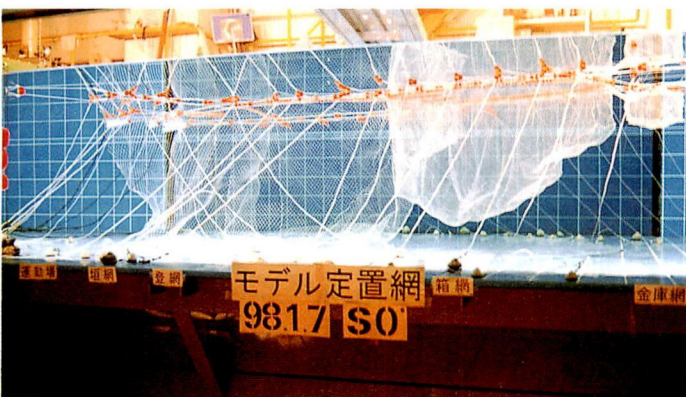
ハイテク定置網の模型（1/150） 県水産総合研究所相模湾試験場（早川）では、毎日、ワイヤーの強度、イカリの固定力、浮子の浮力など研究しています
