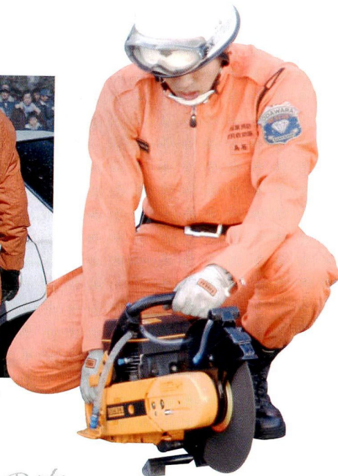
身軽に動ける救助服も難燃性。いざというときには、車のフレームも切り取ることができる大きなカッターで障害物を取り除く。
