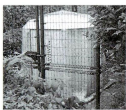
↑市役所敷地内に設置されている震度計。ここでのデータをもとに「小田原市荻窪」の震度が気象庁から発表されます。
