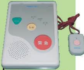
急を知らせる通報装置。ボタンを押せば施設から確認の電話が入ります。
