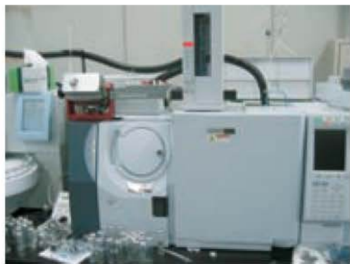
▲寄木細工調査→ヘッドスペース・ガスクロマトグラフ質量分析装置による仕上げ塗料の調査分析
