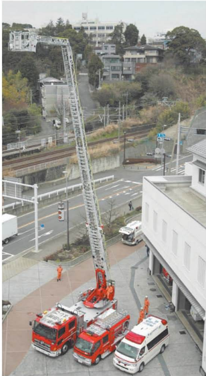
消防ポンプ自動車は新鋭のA-2級ポンプによりすばやく吸水でき、また毎分約2,600ℓ放水ができることで送水能力が格段に向上しました。はしご車は先端部分が屈折することで、活動範囲がさらに広がりました。
