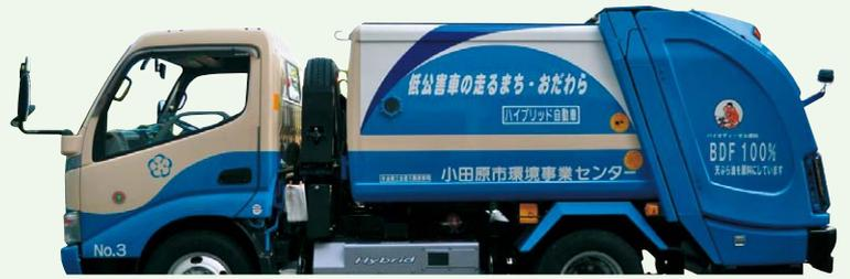
そこで廃食用油をBDFに精製し、ゴミ収集車の燃料に活用できないか検討し、平成20年度に世界でも先進的となる、ハイブリッド仕様のゴミ収集車にBDFを導入しました。昨年には同仕様の車両をもう1台導入しました。今後ともBDF導入のための実証実験を続けていきます。
