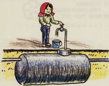
耐震性貯水槽の新設
