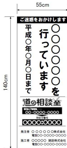
(様式4) 工事説明看板 (占用企業工事)
