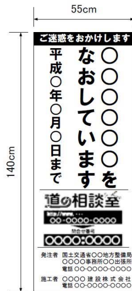
(様式2) 工事説明看板 (道路補修工事)
