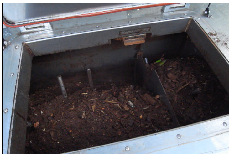
業務用生ごみ処理機の内部
