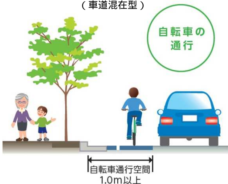
< 図1：自転車通行空間の構造 >
