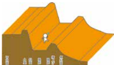
第7図 総構の仕組み模式図
