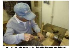
ろくろを用いた挽物加工の様子
