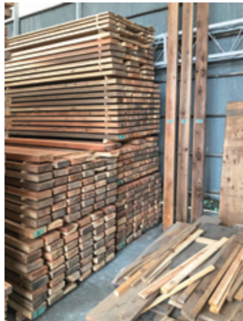
①1次製材され乾燥した小田原産木材。工事に使用する木材の状態を確認。
