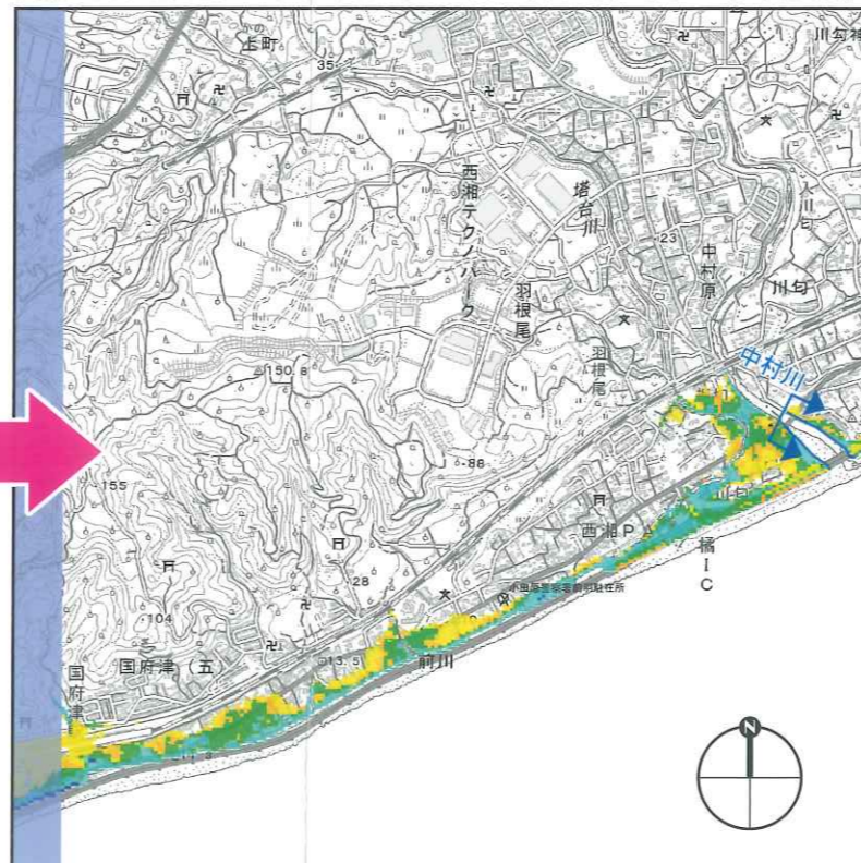
高潮浸水想定区域図 (浸水区域及び浸水深) 【小田原市東部】
