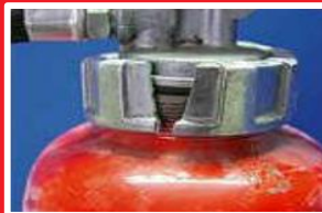
ふたが破損している
