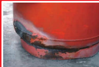
溶接部が腐食している
