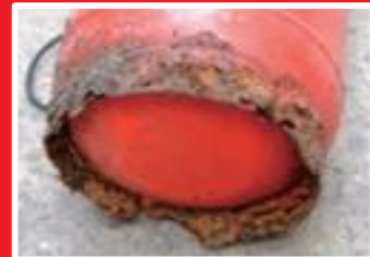
底部がさびている
