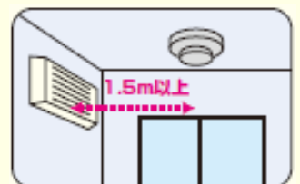
エアコンがある場合、吹き出し口 より1.5m以上離す。
