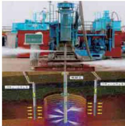
図 8-10 高圧洗浄揚水曝気処理の装置（地上部分）および概念図（地中部分）
