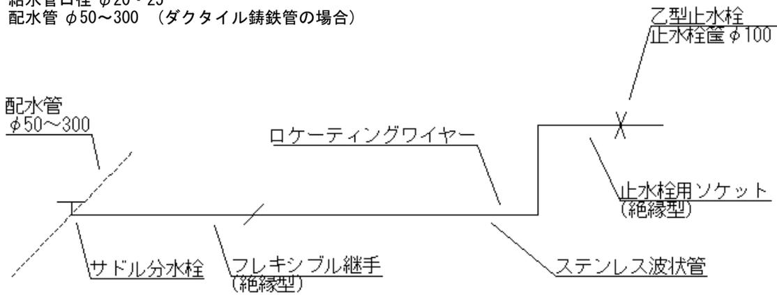
※引込管とメーター口径が違う場合は、止水栓以降で口径変更を行うこと。(メーターブッシュの使用は不可)
