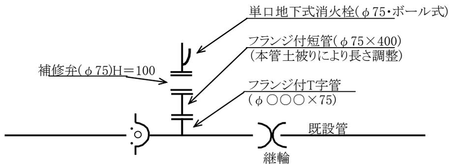
※フランジ各部には、必ず補強金具(3DKN)を使用すること。
