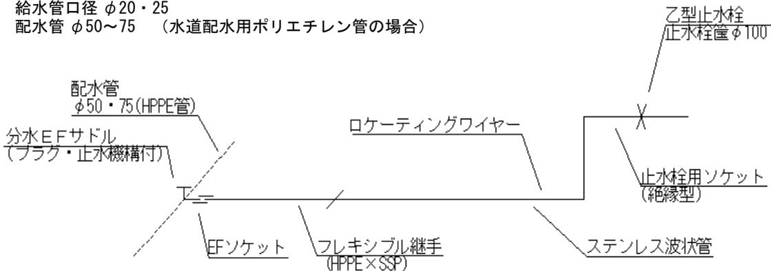
※引込管とメーター口径が違う場合は、止水栓以降で口径変更を行うこと。(メーターブッシュの使用は不可)
