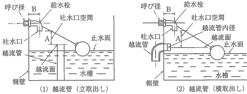
(注：B の設定は呼び径が25mm以下の場合の設定)
