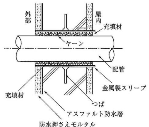
図 4-8-5 配管スリーブの設置例
