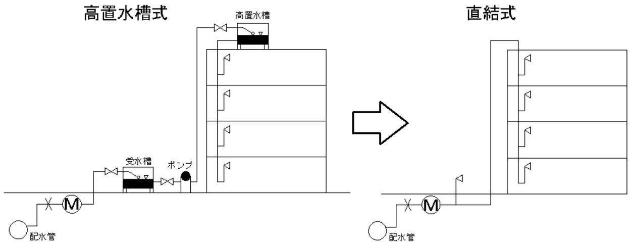
(3) 高置水槽式 ⇒ 直結式 (高置水槽方式) 貯水槽式
