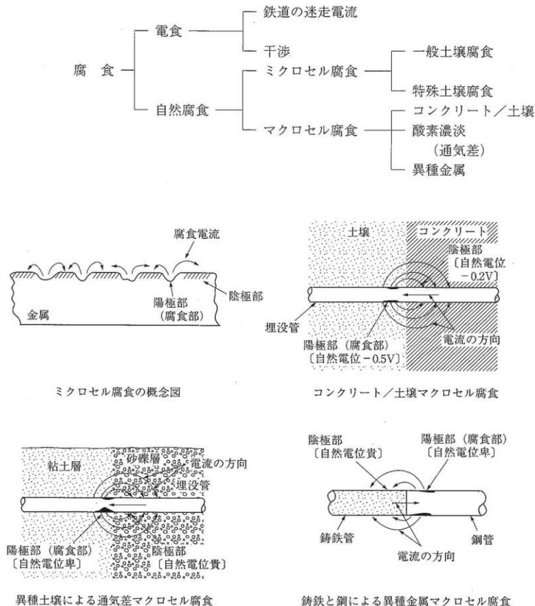
図 4-8-6 金属管の腐食の分類
