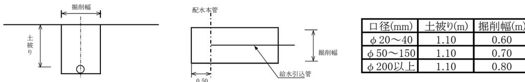
12. 土留工は、必要に応じ行うこと。ただし、掘削深さが1.5m以上の場合、または軟弱地盤や湧水があり崩壊の危険がある場合は、必ず土留工を行って掘削すること。
