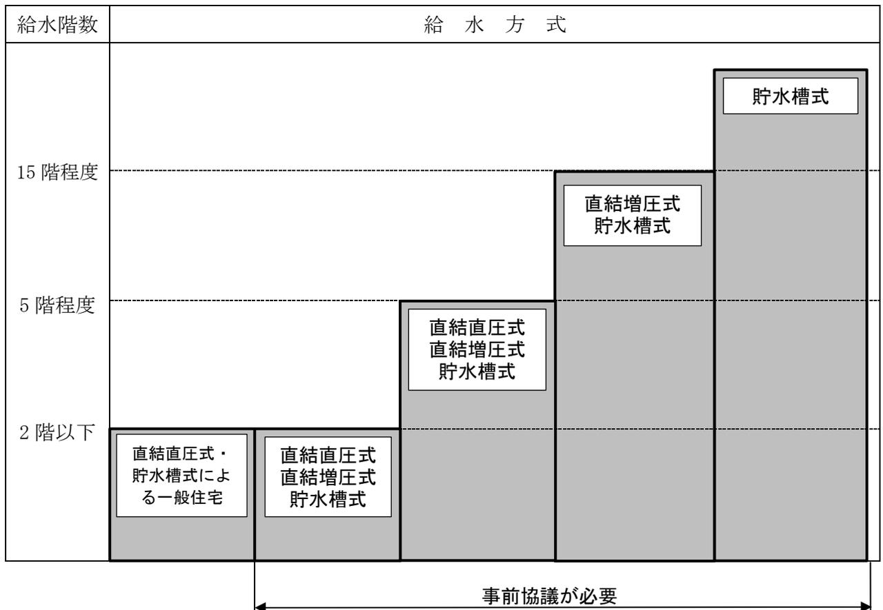
図 2-4-2 給水階数による給水方式の選択例
