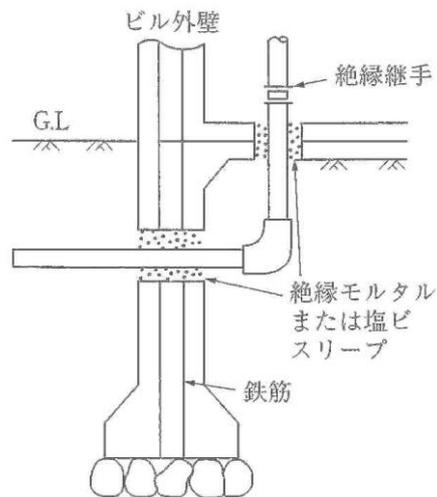
図 4-8-13 ビルに入る配管の絶縁概要図
