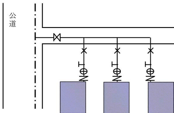
5. 止水栓の取り付けは下図を参考として設置すること。
