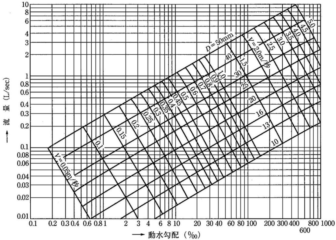
図 2-6-3 ウェストン公式による流量図
