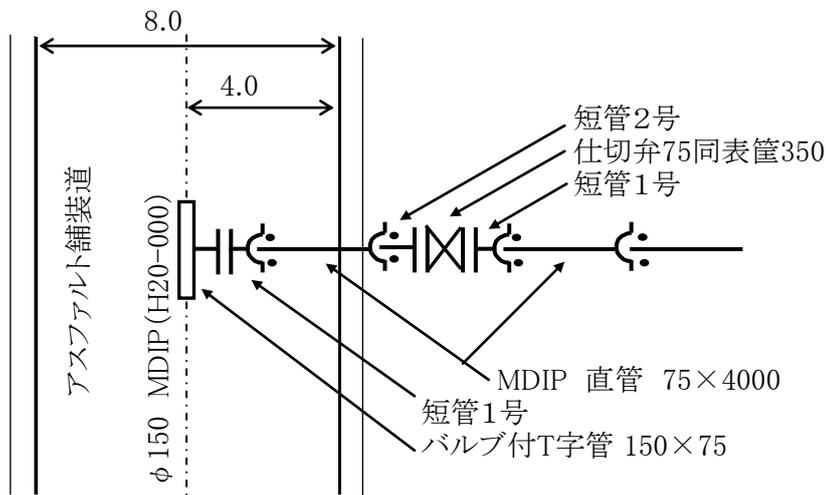
図 5-3-8 詳細図 (引き出し図例)
