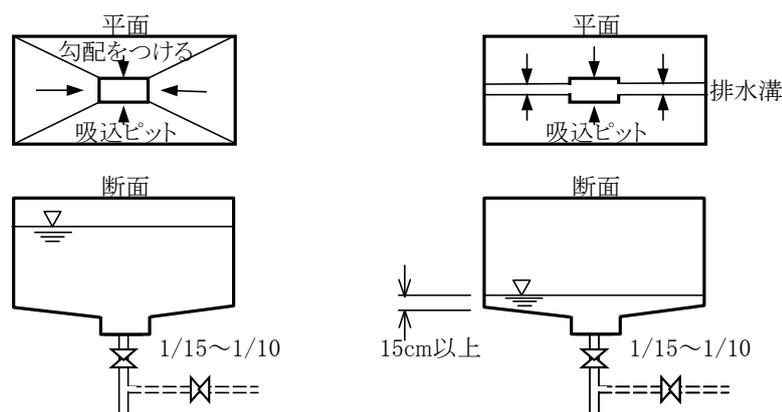
※ 水抜管の管端は間接排水とする。
