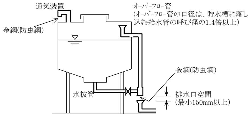
※ オーバーフロー管、水抜管及び通気装置は、いずれも取り付けの1例を示したもので、最も好ましい例として示したものではありません。
