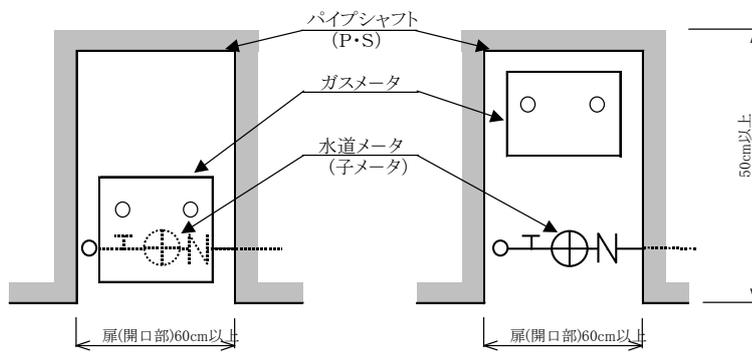
(注) 断面的にみて水道メーターとガスメーターの位置がずれていて、水道メーターの取り外し及び 検針が支障なくできる場合には、上下の間隔は、考慮しなくてもよい。
