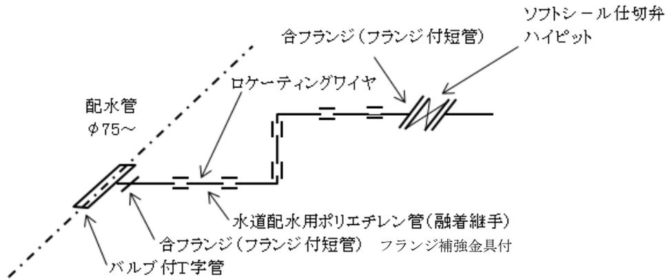
※配水管口径と取出する給水管口径の同径の分岐は、不可能とする。
