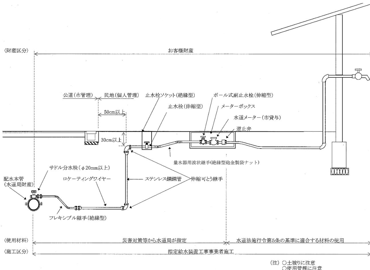
図 2-3-1 給水装置の構成標準図
