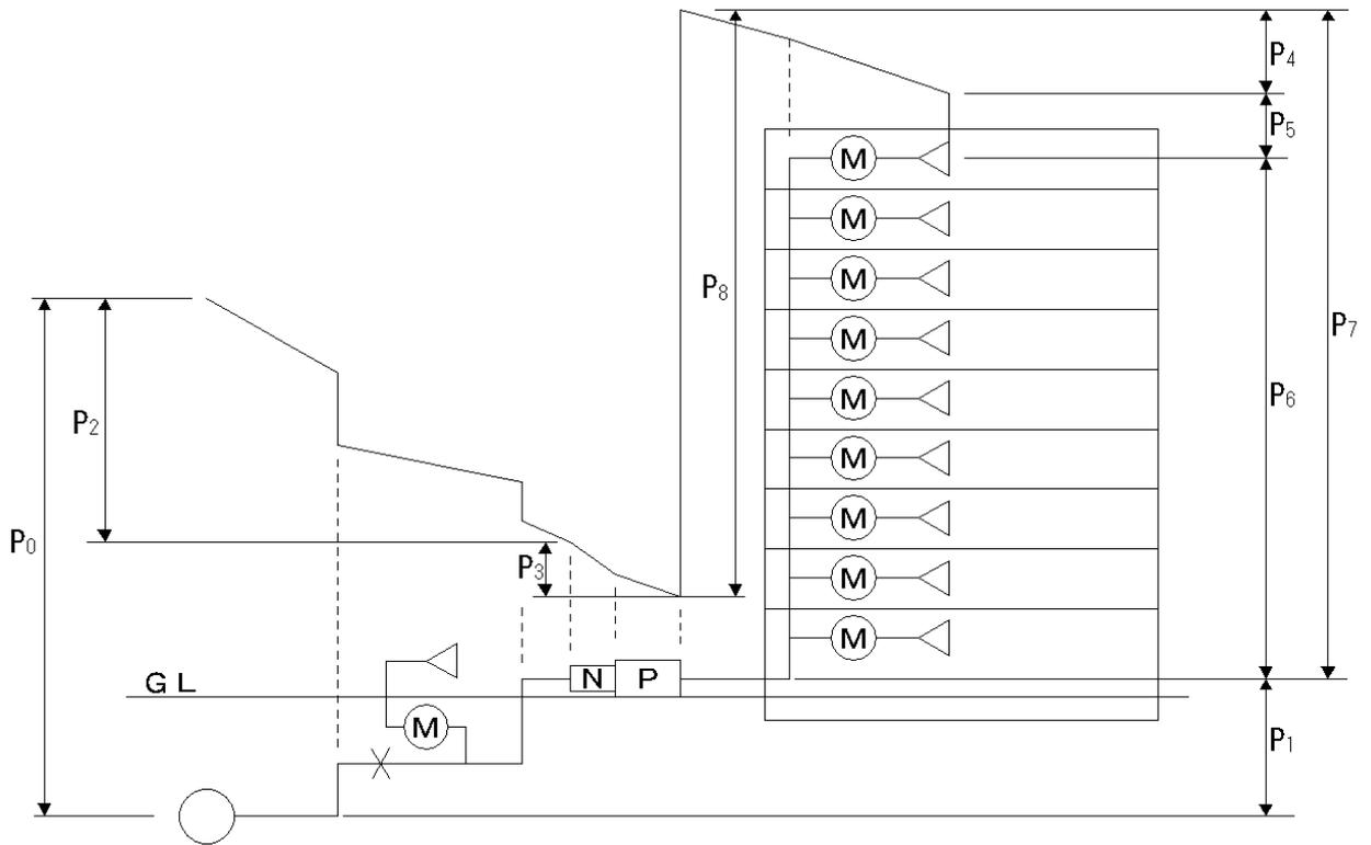
$P_0$  : 配水管圧力【設計水圧：直結給水事前協議圧回答書による】
