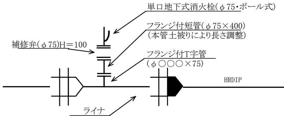
※フランジ各部には、必ず補強金具(3DKN)を使用すること。
