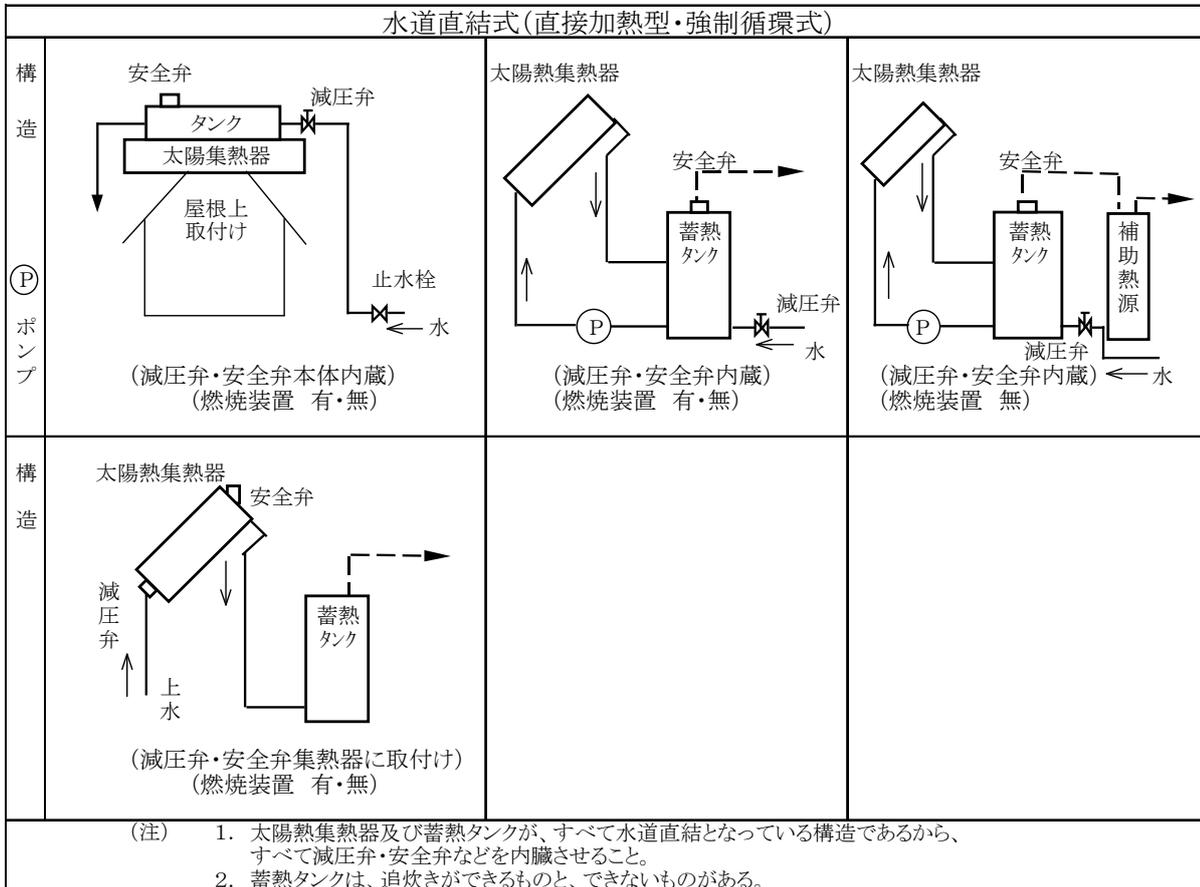
備考 二回路式も、水道直結式も、太陽集熱器の高さ、循環ポンプの揚程が種々あるが、いずれも蓄熱タンクの内圧に影響を及ぼさぬ高さ、揚程とする。
