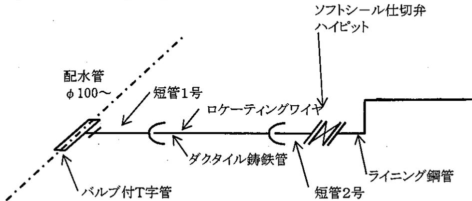
※ダクタイル鋳鉄管  $\phi 75 \sim$  は、すべて GX 型とする。
