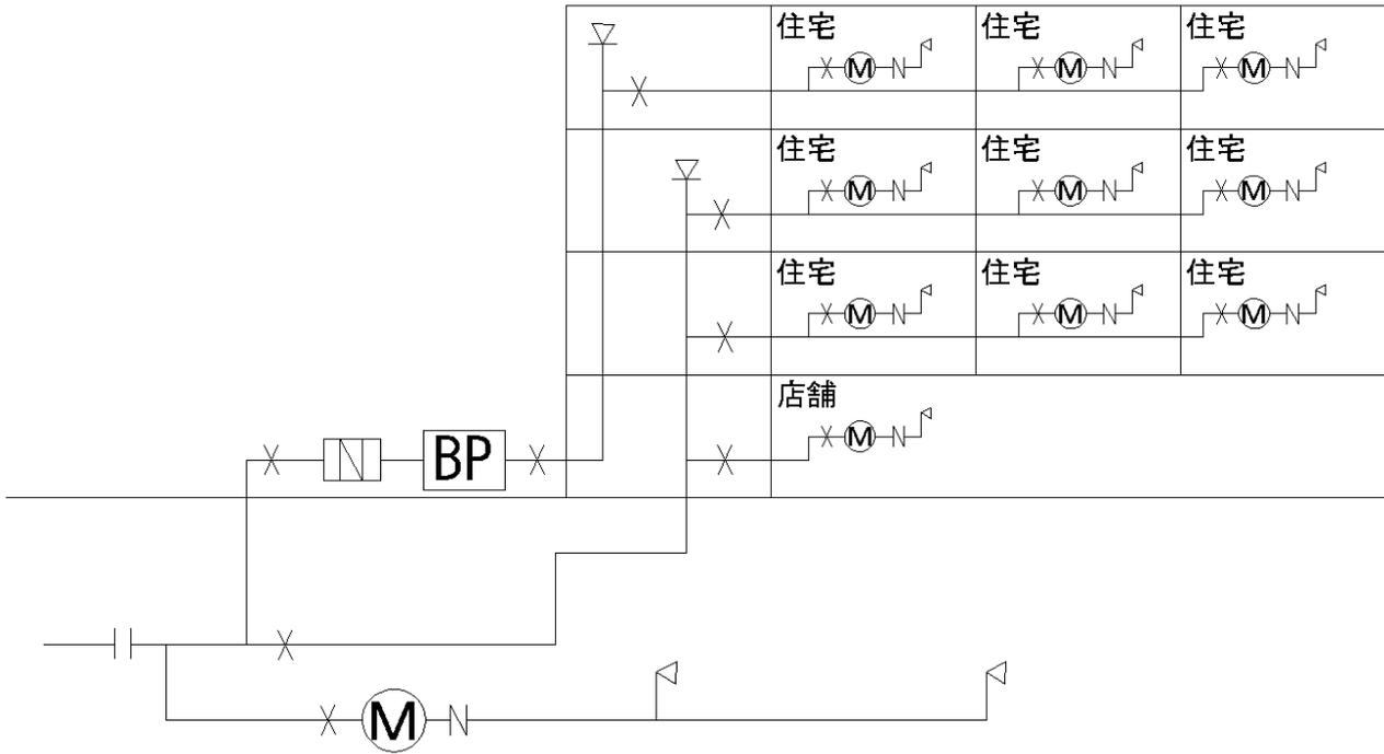
⑤ 店舗併用共同住宅（直結増圧式+直結直圧式+貯水槽式：各戸検針）
