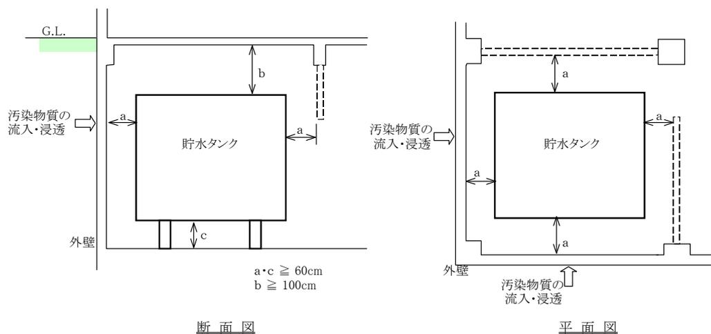
図 7-2-2 貯水タンクの設置位置の一例
