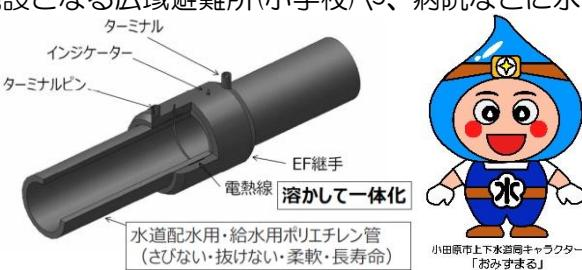
新しく入れ替える水道管は、柔軟性に優れ、継手部が抜けず(一体化)に、大地震の揺れや地盤沈下に対しても、破損や漏水を防ぎます。
