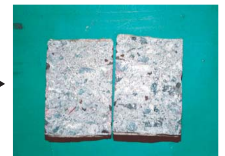
圧縮試験後、割裂
