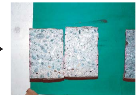
圧縮試験後、割裂
