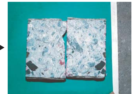
圧縮試験後、割裂
