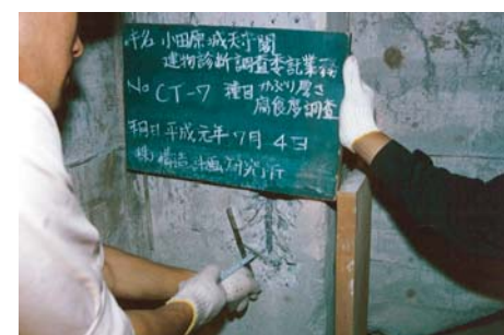
鉄筋被り暑さ・腐食度調査
